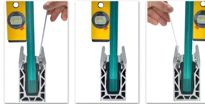
L'ingéniosité du système Fender réside dans l'utilisation d'une pince de maintien, hautement performante qui, à l'aide d'une vis de chaque côté du vitrage, permet un réglage individuel SANS COIN DE CENTRAGE.
