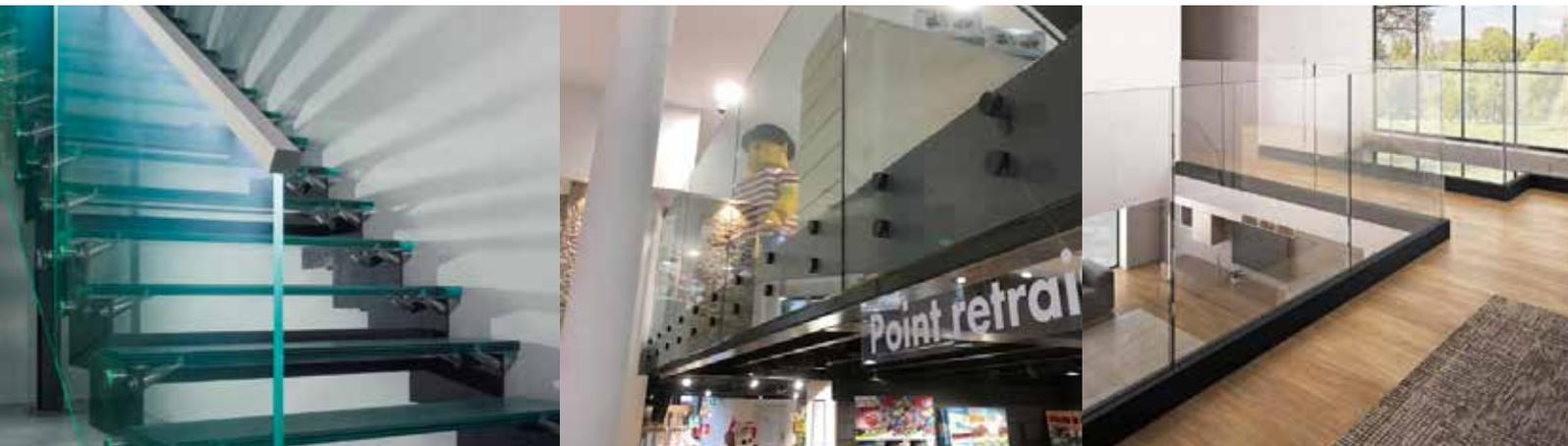
Le verre feuilleté est un assemblage de 2 vitrages minimum, liés entre eux par des intercalaires techniques. En tant que transformateur indépendant, notre équipement industriel nous permet de réaliser des **assemblages feuilletés certifiés, conformes et sécuritaires**.
